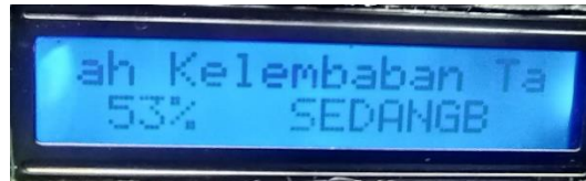
Gambar 10 Tampilan LCD Kelembaban Tanah Sedang
