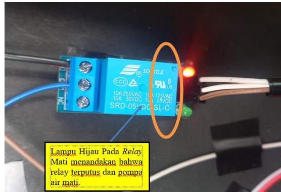
Gambar 13 Foto Pada Relay Pada Kondisi Terputus
